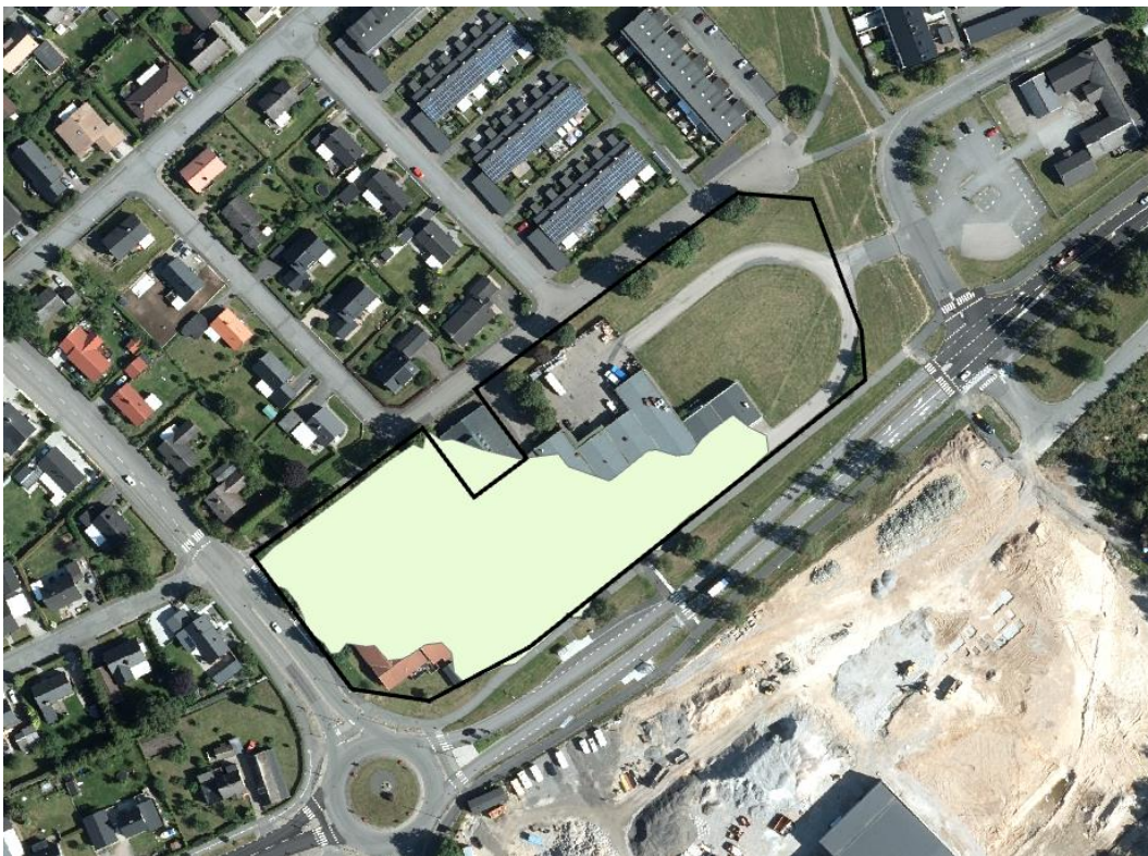
Figur 13. Avrinningsområdet i Dämnet västra som användes för dagvattenavrinning visas i grön (Scalgo Live, 2022).
